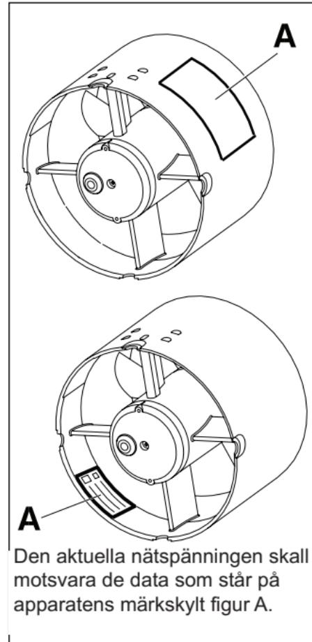
Den aktuella nätspänningen skall motsvara de data som står på apparatens märkskyt figur A.
