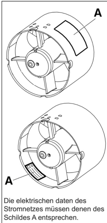
Die elektrischen daten des Stromnetzes müssen denen des Schildes A entsprechen.
